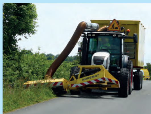
Matériel FAE : broyeur latéral. © Cerema
