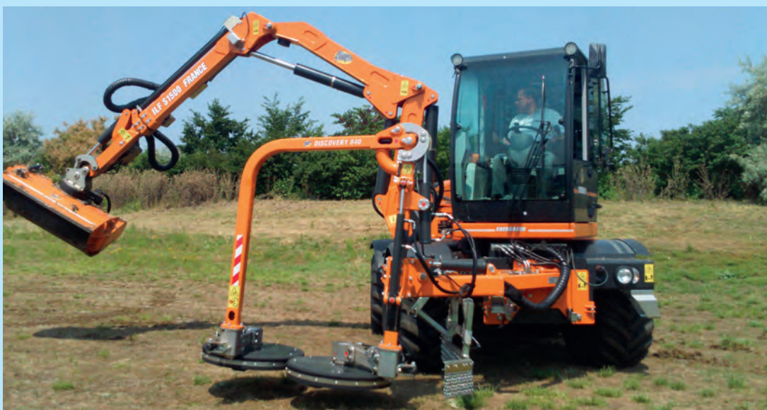
Tracteur équipé d'un broyeur et d'une faucheuse sous glissière. © Cerema
