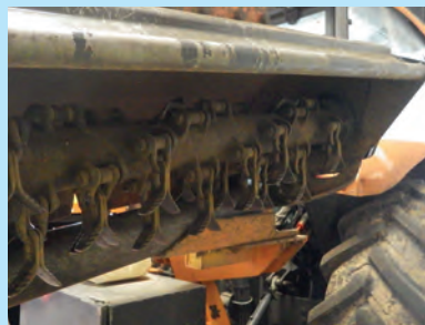
Broyeur couteau et rouleau palpeur. © Cerema
